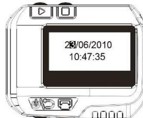
Im Sekunden- Einstellprozess angelangt, wird durch Betätigen der Taste
