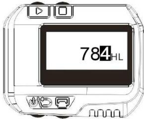
7. Durch Betätigen der Taste
