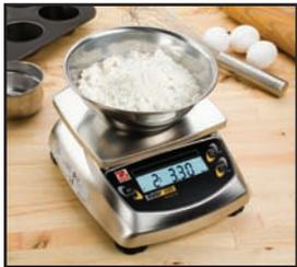
**Bestimmung des spezifischen Gewichts** – Dieser Modus ist ideal für die schnelle und leichte Bestimmung des spezifischen Gewichts einer Probe, ohne dass manuelle Berechnungen durchgeführt werden müssen. Dies ist nicht nur wichtig beim Testen von Stoffen, sondern auch nützlich bei der Überprüfung der Belüftung in Lebensmittelverarbeitungs- und Lebensmittelserviceanwendungen.
